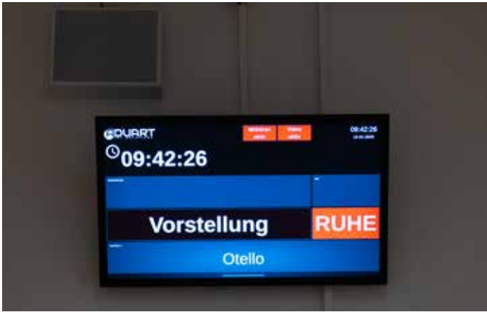
Eines der neuen Info-Displays, die vom Inspizientenpult gesteuert werden. Fotos: Graner+Partner [3]
