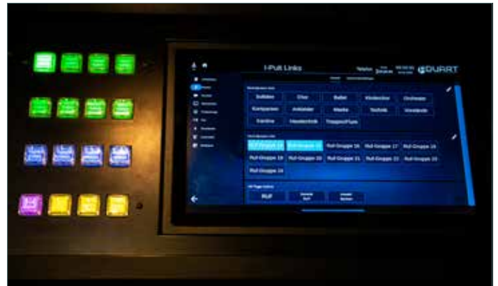
Touchpanel des Inspizientenpults mit Auswahl der Hausruf-Gruppen. Foto: Graner+Partner
