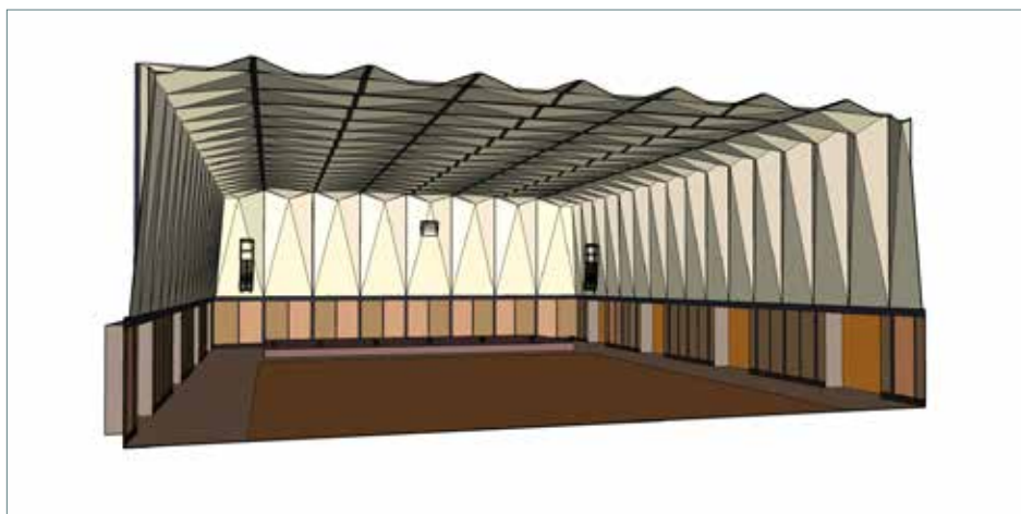
Grafisches Modell für akustische und beschallungstechnische Simulationen im Großen Saal. Grafik: Graner + Partner Ingenieure GmbH
