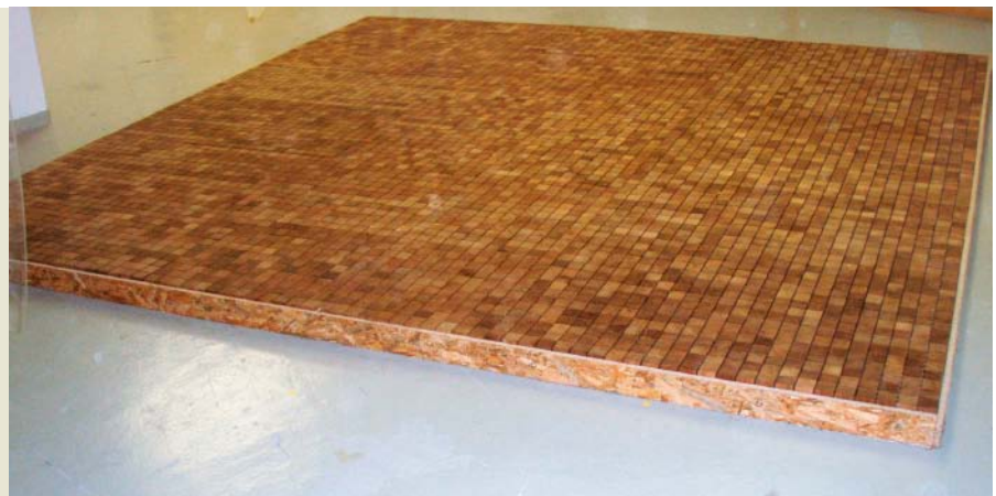
Test. Prototypen der Mosaikpaneele wurden im Hallraumlabor des Akustikbüros montiert, um die Schallabsorption zu ermitteln.
